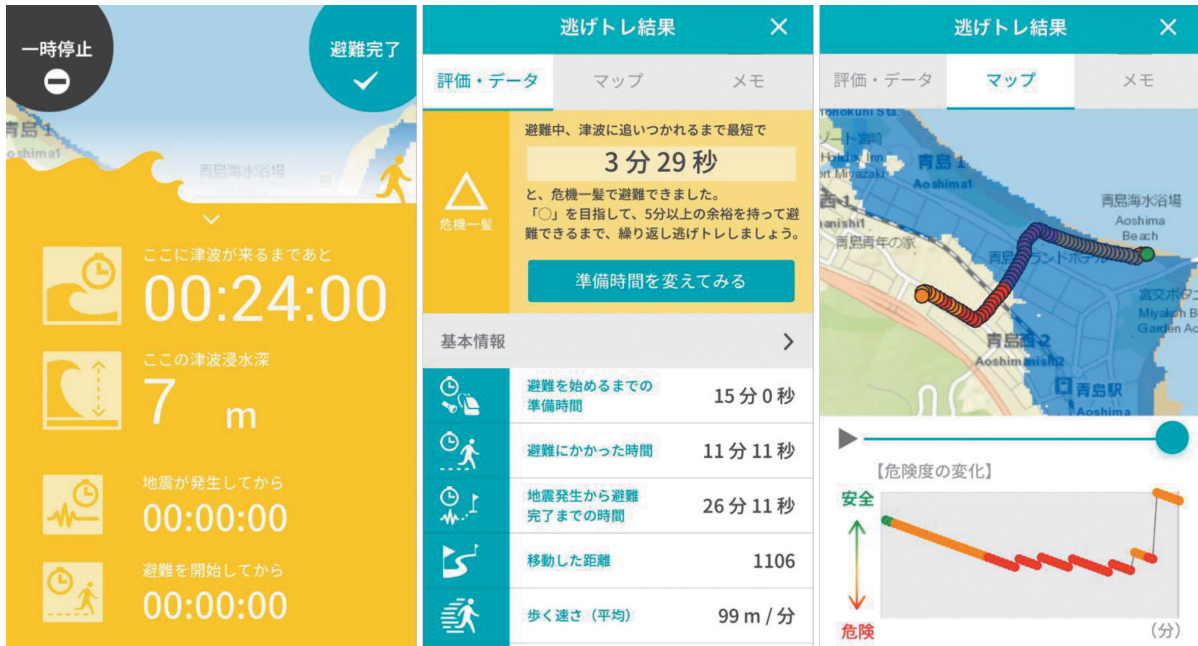
図3 逃げトレの画面例。(左) アプリを立ち上げた直後の状況。その地点での津波到達までの時間(24分)と最大浸水深(7m)を知ることができる。(中) 逃げトレ結果の評価・データ。津波に追いつかれるまでの最短時間や避難にかかった時間などが表示される。(右) 逃げトレ結果のマップ。避難の軌跡が○で示されており、色は危険度を示している。地図中の青く色が付いた領域は津波の浸水が始まった場所で、アプリ上では時間と共に広がっていく様子が見て取れる。
